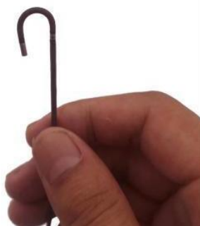
Зонды – диаметрами от \varnothing 1,2 мм до \varnothing 8,3 мм
